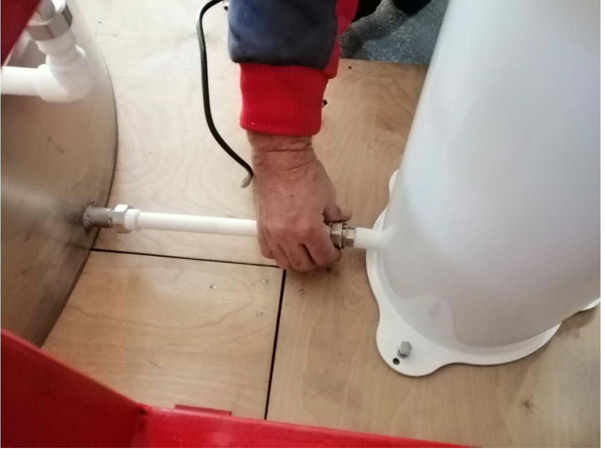
Resim 6. Ölçüm Kulesinin Buharlařma Kazanına Baęlanması
