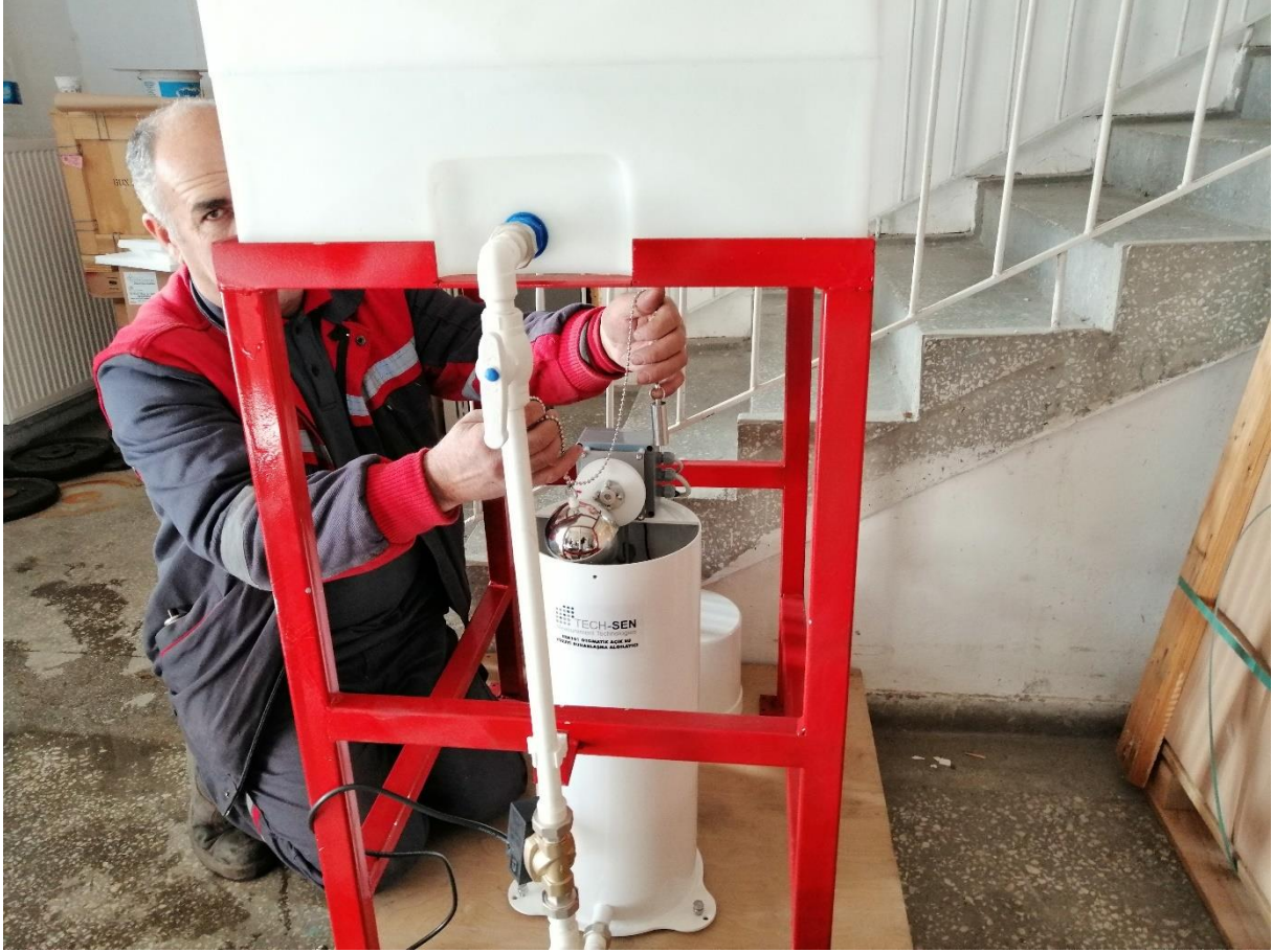
Resim 8. Şamandıra ve Ağırlığın Ölçüm Kulesine Takılması
